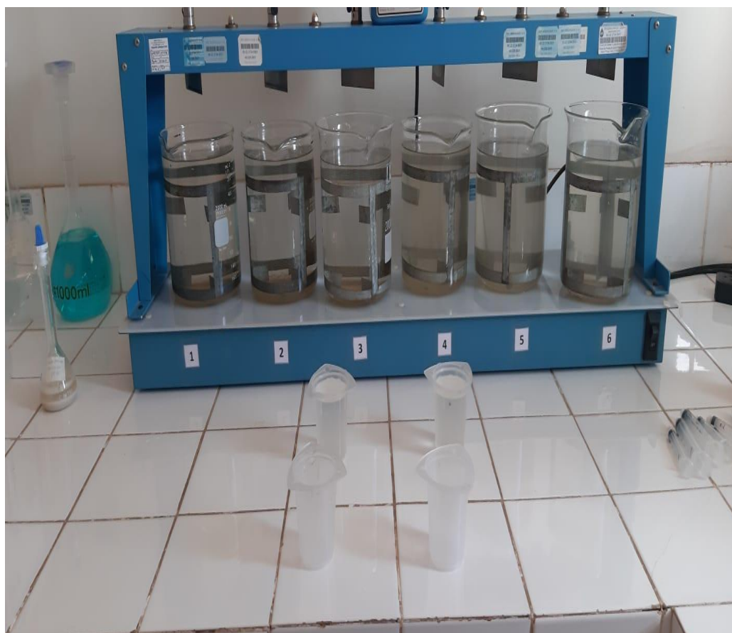
Ejecución de la prueba de jarras (Jar Test)
